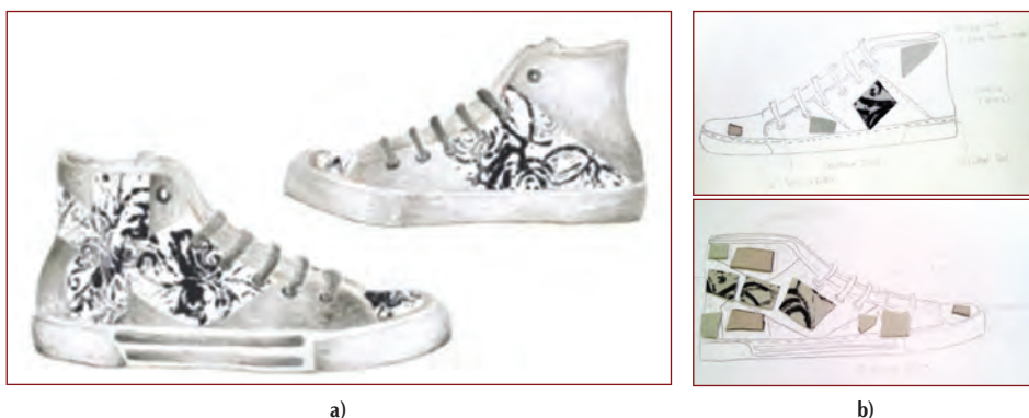
Slika 4. Razrada idejnog rješenja za izradu uzorka: idejno rješenje tenisica (a) i skica modela vanjske i unutrašnje strane rađena prema kalupu (b) [4]
