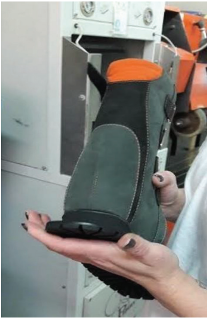
Slika 8. Lijepljenje polugotovog PU potplata
