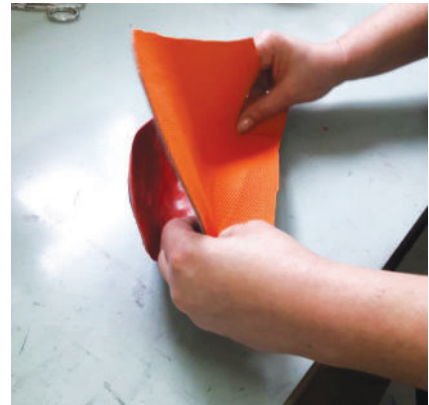
Slika 10. Lijepljenje podstave na uložak
