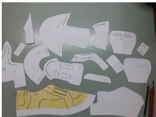
Slika 5: Šablone krojnih dijelova gornjišta cipela.
