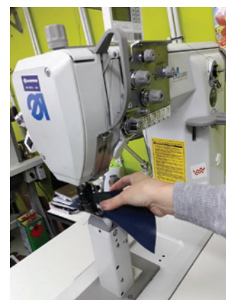
Slika 8: Šivanje dijelova gornjišta.
