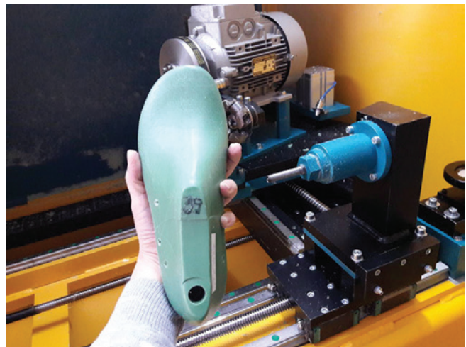
Slika 4: Kalup izrađen na CNC stroju za glodanje.
