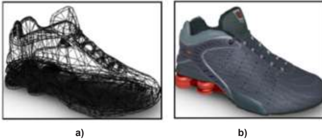
Slika 6. 3D model obuće je sastavljen od ovih dijelova: a) Geometrija – oblik se opisuje kao kostur 3D modela obuće; b) Tekstura – je slika koja prekriva 3D model poput omota te time dobiva realniji izgled
