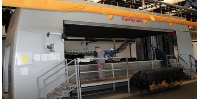
Slika 3. Vakuum uređaj za sušenje kože tt. Cartigliano
