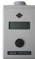
Slika 4. Uređaj za mjerenje apsorbirane vlage u koži
