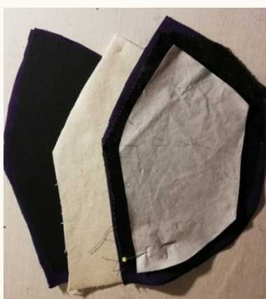
Slika 13. Prikaz krojnih dijelova košarice-osnovna ljubičasta pamučna tkanina s Centilinom 100 g/m 2 , u sredini bijela pamučna tkanina i ljubičasta pamučna tkanina s Centilinom 130 g/m 2 (autorski rad).
