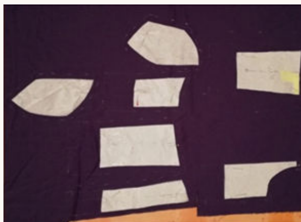
Slika 3. Krojni dijelovi korzeta s košaricama postavljeni na osnovnu tkaninu (ljubičasta pamučna tkanina), (autorski rad).
