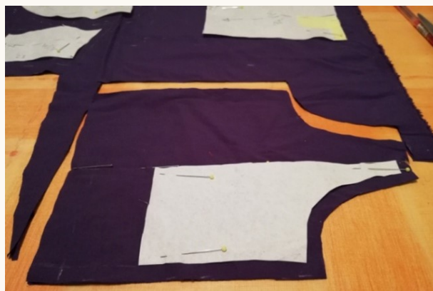
Slika 4. Krojenje prednjeg srednjeg dijela korzeta iz osnovne tkanine s produženjem na duljini korzeta za 7 cm (autorski rad).
